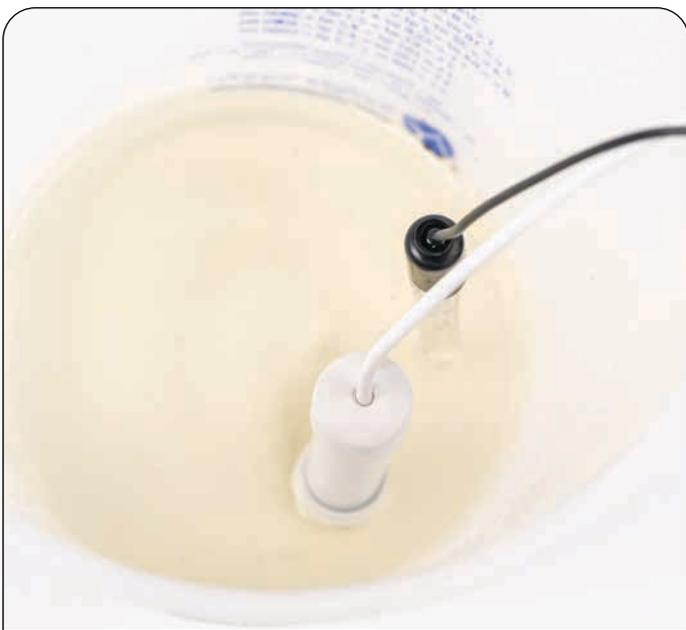
**2** Coloca un medidor de EC y pH calibrado en la taza de medición para obtener una lectura.
